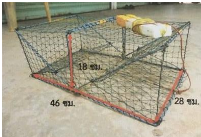
ภาพที่ 1 ลอบแบบพับได้ (Collapsible crab trap)
