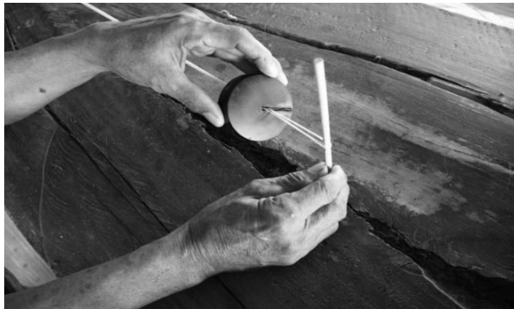
ภาพที่ 6 การนำด้ายสอดเข้าไปยังจุดศูนย์กลางของแป้นหมุ่นผ่านเส้นรัศมี
