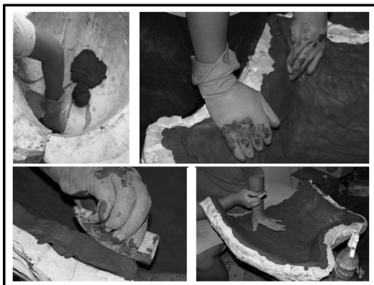
ภาพที่ 26-29 การนำดินเข้าอัดในพิมพ์
